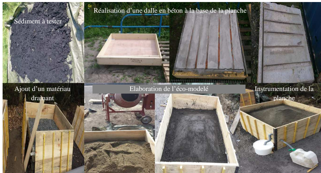
Figure 14. Etapes de réalisation d'une planche expérimentale pour l'étude d'un d'éco-modélé paysager
