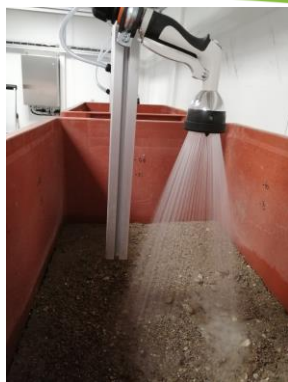
Fig. 1 : Photo de la planche expérimentale en percolation
